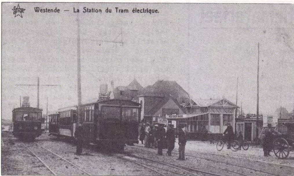
Het eindpunt van de elektrische tramlijn te Westende. Twee gesloten North-rijtuigen (met NMVB-waggenummer en gesloten windschermen) staan klaar om te vertrekken naar Oostende. Het rechtse rijtuig sleept 2 open aanhangrijtuigen (één van de reeks 8768-8771 en één van de reeks 8760-8767). (verzameling Paul De Backer)
