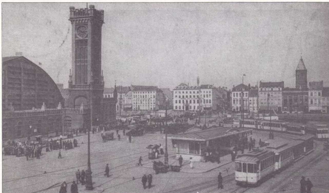
Twee elektrische kusttrams voor het station van Oostende. De tram op de voorgrond, komende van Westende, sleept o.a. twee oude open aanhangrijtuigen afkomstig van de Compagnie North. (archief NMVB)
